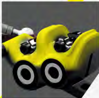
TRIPLE ARCH DESIGN Ultimate brake caliper rigidity 三拱橋設計 提供卡鉗絕佳剛性
