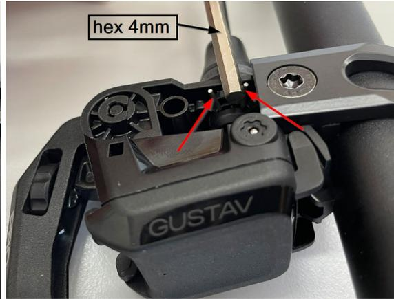
5. Bei **not OK** die beiden Arme des Federclips Easy Link zusammendrücken, z.B. mit einem Schraubendreher oder vorsichtig mit einer Spitzzange.
