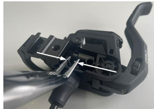
6. Bremsleitungsverbindung durch festes Ziehen an der Leitung überprüfen.
